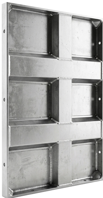
Cimbra de Aluminio 6160-T6 | Espesor 3.5 mm. 90 cm x 2.10 m, pesa aproximadamente 41 kg a 43 kg
